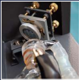
Espejo No.1 Espejo al lado del tubo láser.
