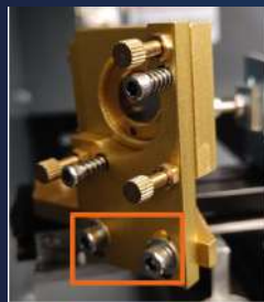
Tornillos conjunto espejo No.2 para movimiento vertical.
