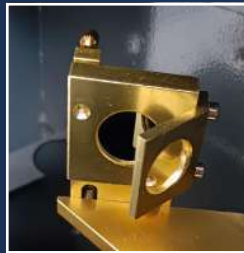
Espejo No.2 Segundo espejo encontrado en el lado izquierdo del eje X.
