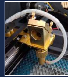
Espejo No.3 Tercer espejo localizado en la boquilla.
