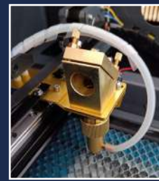
Espejo No.3 Tercer espejo localizado en la boquilla.
