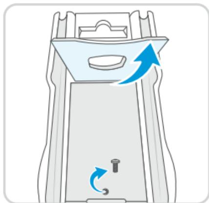
2 Extrae el compartimento, y coloca las baterías. Asegúrate de que la polaridad sea la correcta.
