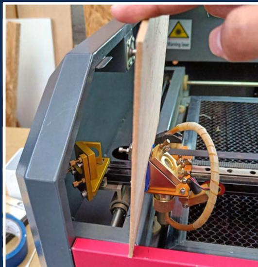
14. Una vez la marca se encuentre dentro del área del espejo No.2, o muy cercano a esta, debes colocar un masking en el aro del espejo No. 3.
