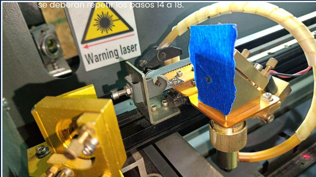
19. Después de lograr que el láser se mande de forma recta y ambas marcas coincidan, revisa que el láser se encuentre centrado en el aro del espejo, haz uso de los tornillos para mover el conjunto del espejo No.3
